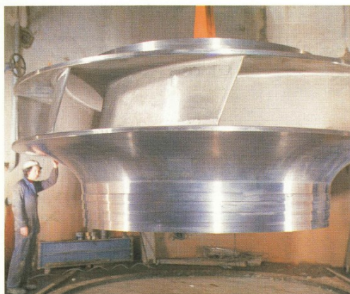
Roue de turbine-pompe
